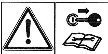
**N° 51:** Couper le moteur du tracteur et retirer la clé de contact avant de commencer les travaux d'entretien ou de réparation.
